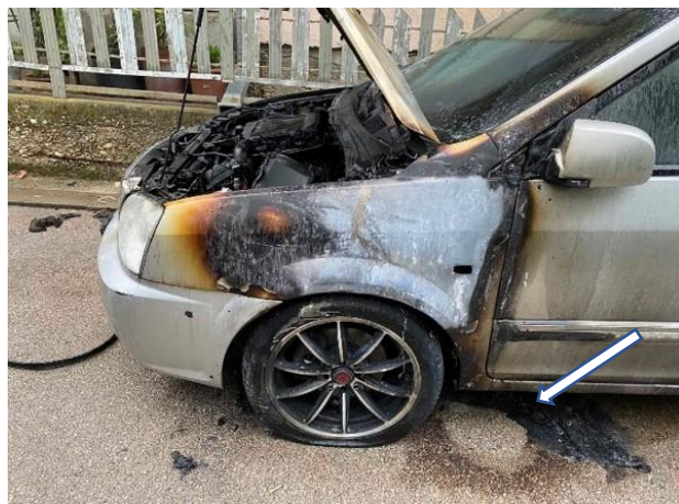
Фотографија 9: Траг сливања поспешивача горења на чврстој подлози (асфалту)
