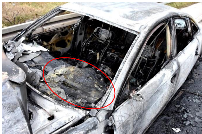
Фотографија 6: Ветробранско стакло са траговима бурне реакције у левом делу, у виду жуто-браон пребојавања, што у десном делу није случај. Овакав траг јасно прецизира место про-ливања поспешивача горења иако је возило у потпуности захваћено пожаром
