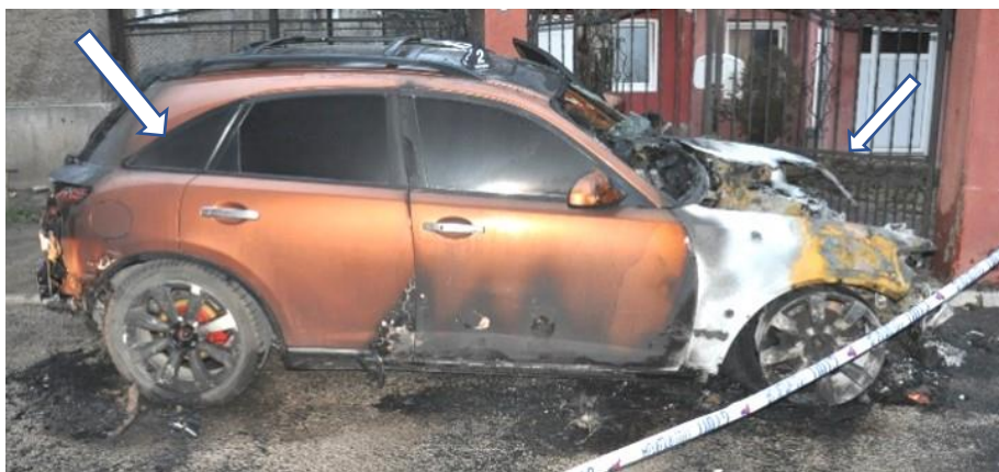
Фотографија 2: Два центра пожара на возилу приказана стрелицама
