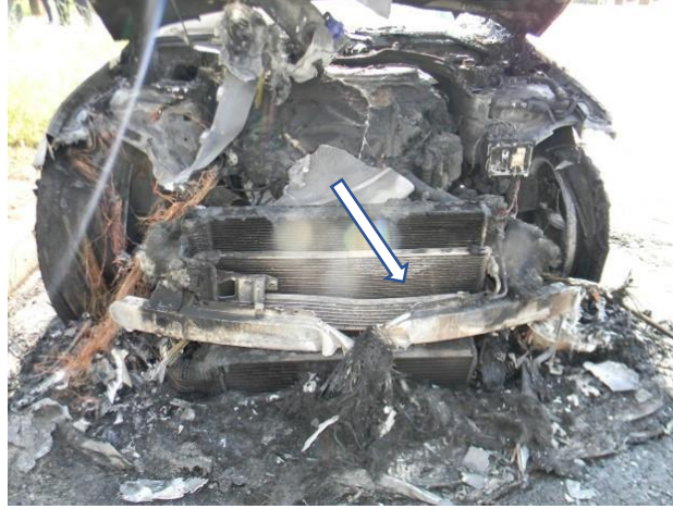
Фотографија 8: Оштећење на средини металног браника као последица локалног дејства поспешивача горења у виду "левка"
