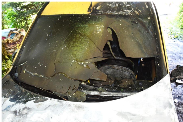
Фотографија 4: Плочасто пуцање и раслојавање ветробранског стакла, са карактеристичним мехуровима јасно уочљивим по средини стакла
